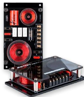
2-Wege High End SQ Frequenzweichen-Set, bestückt mit hochwertigen Bauteilen, speziell abgestimmt für den Einsatz mit den ETON GRAPHIT Systemen, Pegelanpassung des Hochtöners um -2/ 0 /+2 dB. Anpassung der Flankensteilheit des Tiefmitteltöners um 6 und 12 dB/Okt., Abmessungen (L x B x H): 163 x 94 x 36 mm, Engineered in Germany.
