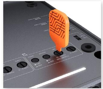
**Top Control:** Bei den MA- und PA-Verstärkern befinden sich die Einstellmöglichkeiten unter der abnehmbaren gefrästen Topplatte aus Aluminium.
